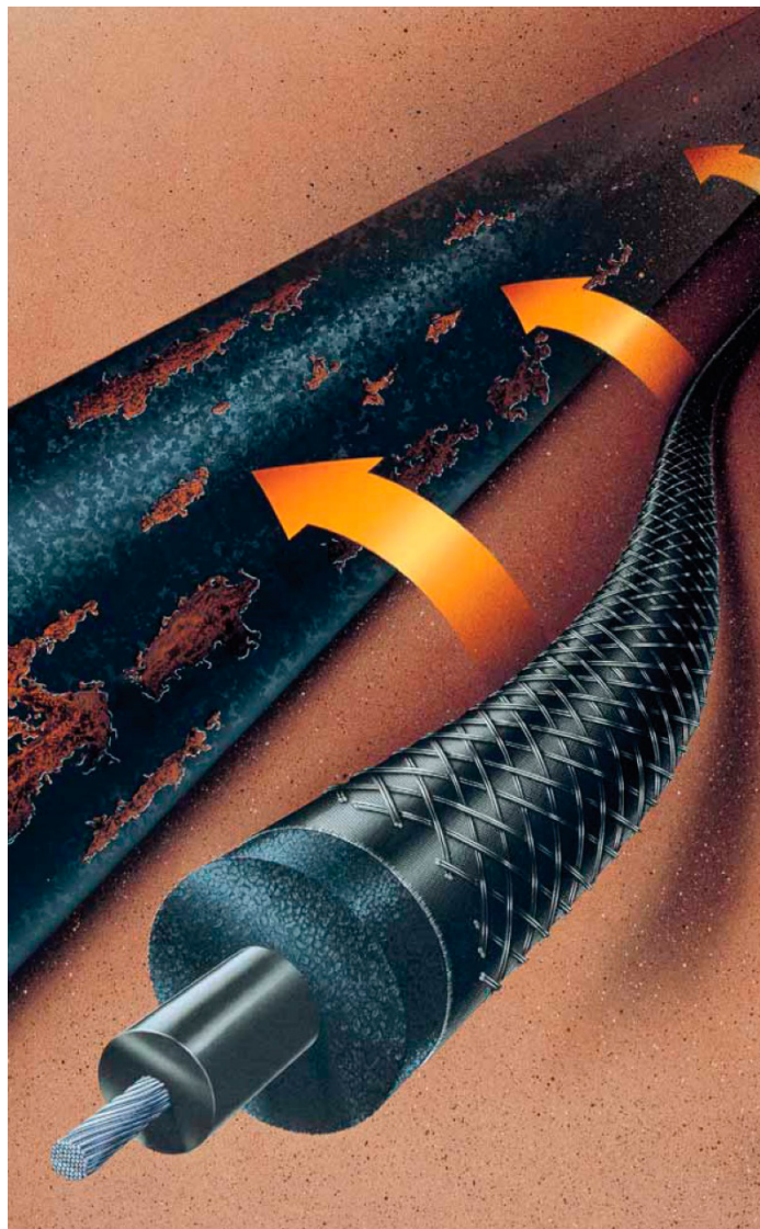
Rozdíl distribuce potenciálu podél potrubí lineární anody proti diskrétní anodě.
